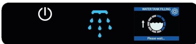
*(Las gotas empiezan a brillar en azul de abajo a arriba. Esta pantalla muestra que la máquina está tomando agua y las fracciones en la pantalla muestran la cantidad de llenado).*
