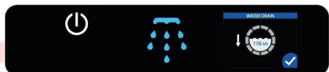
*(Las gotas empiezan a brillar en azul de arriba hacia abajo. Esto indica que la máquina está evacuando agua. Las fracciones que aparecen en la pantalla indican la cantidad evacuada).*
