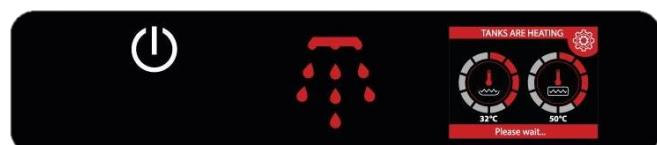
*(Las gotas empiezan a enrojecer de abajo a arriba. Esta aplicación indica que las temperaturas de la caldera y del agua de la caldera de la máquina se están aumentando. Las fracciones que aparecen en la pantalla muestran la cantidad de calentamiento)*
