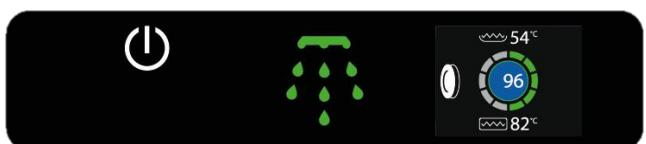
*(Las gotas se vuelven verdes. Esto indica que la máquina ha iniciado el lavado. Las fracciones que aparecen en la pantalla indican la cantidad de lavado).*
